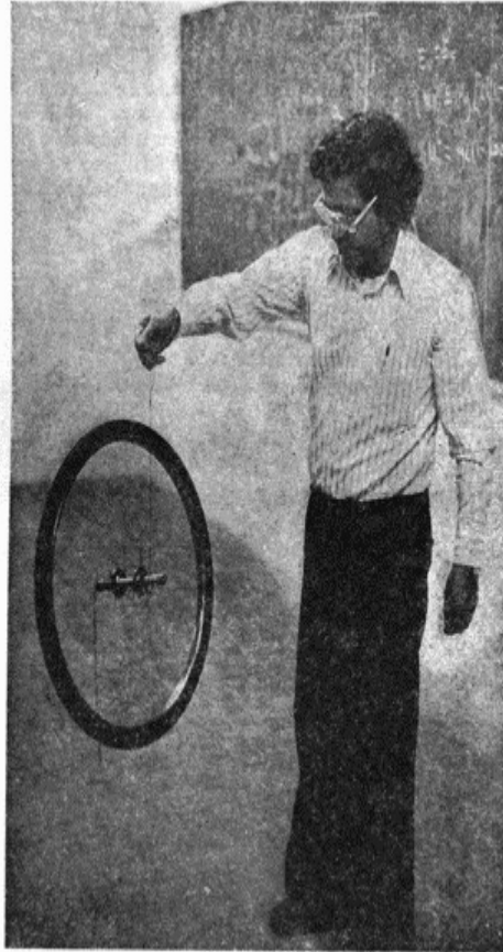
FIG. 13. Giróscopo de rueda de bicicleta precesiendo alrededor de un eje vertical.
